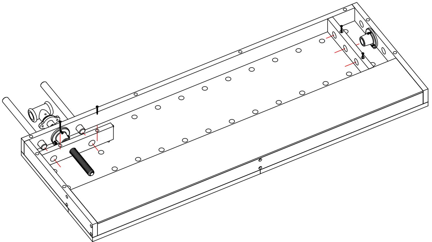
Шаг 8. Зафиксировать столешницу к основанию верстака при помощи саморезов.
