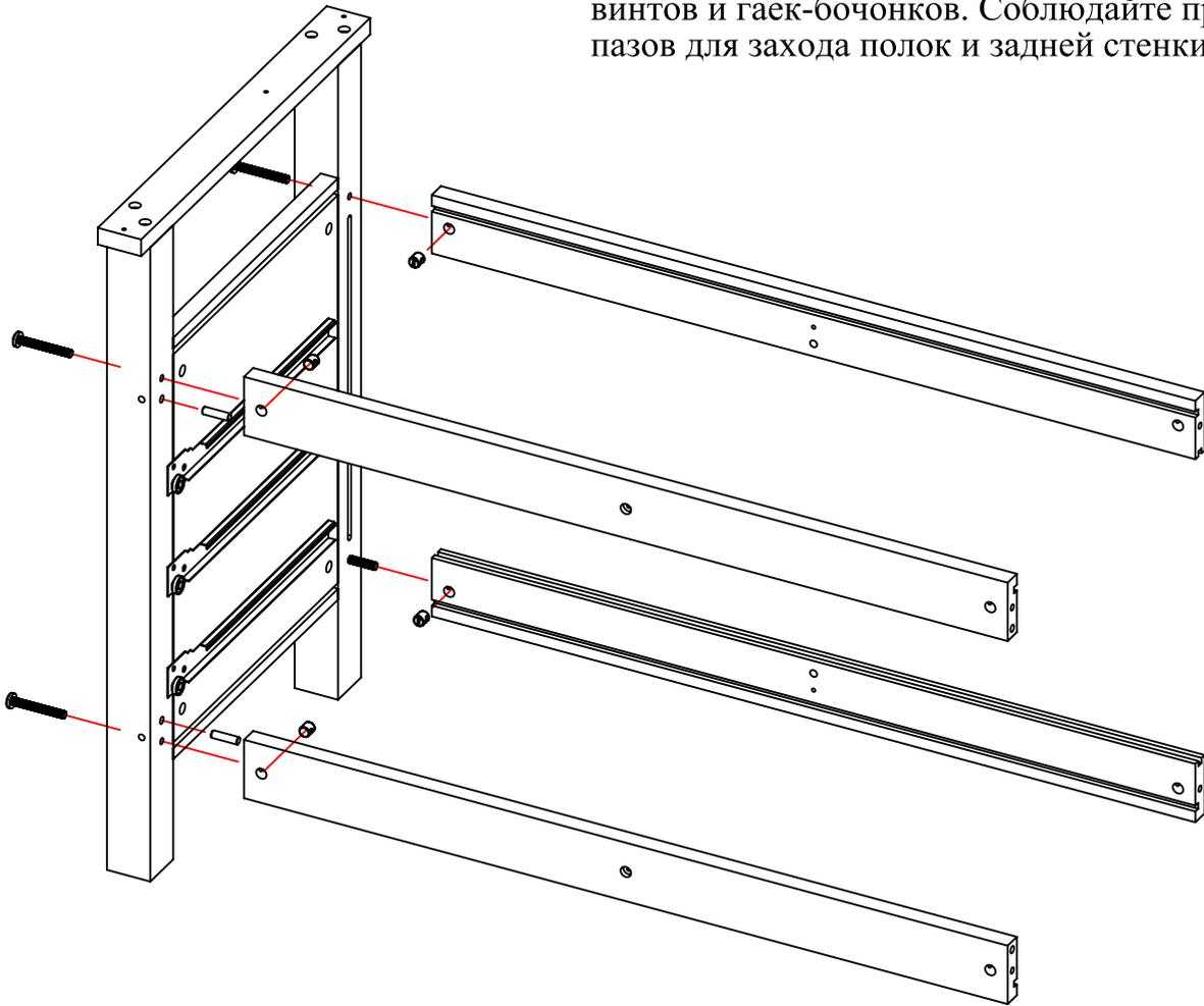
Шаг 2. Установить до упора в пазы поперечин полки и заднюю стенку.
