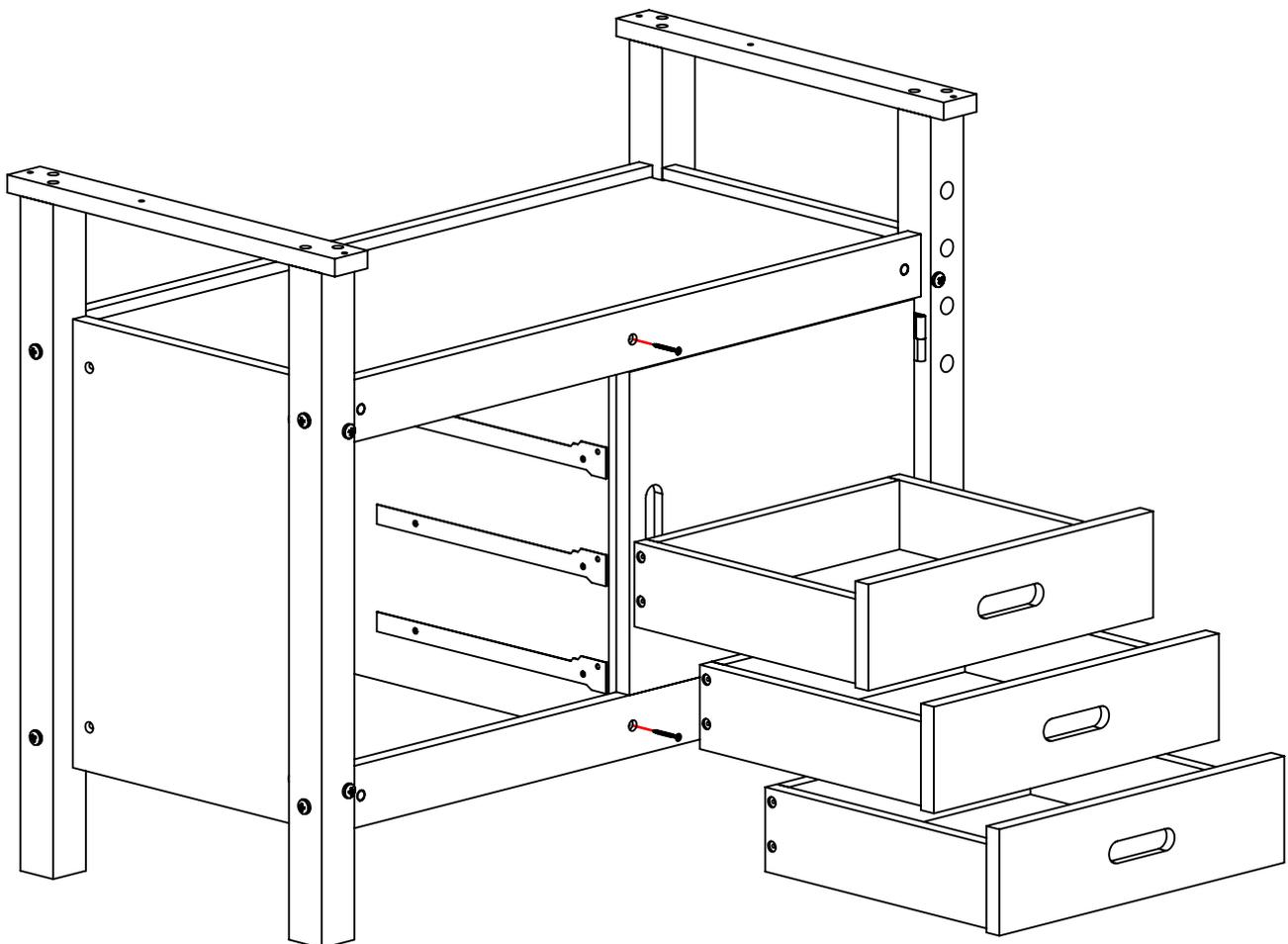
Шаг 7. При помощи малых и длинных саморезов, к внутренней части столешницы прикрепить две упор-гайки и две поперечины, соблюдая соосность под винт и направляющие. Убедившись в плавности хода, выкрутить винт и извлечь направляющие.
