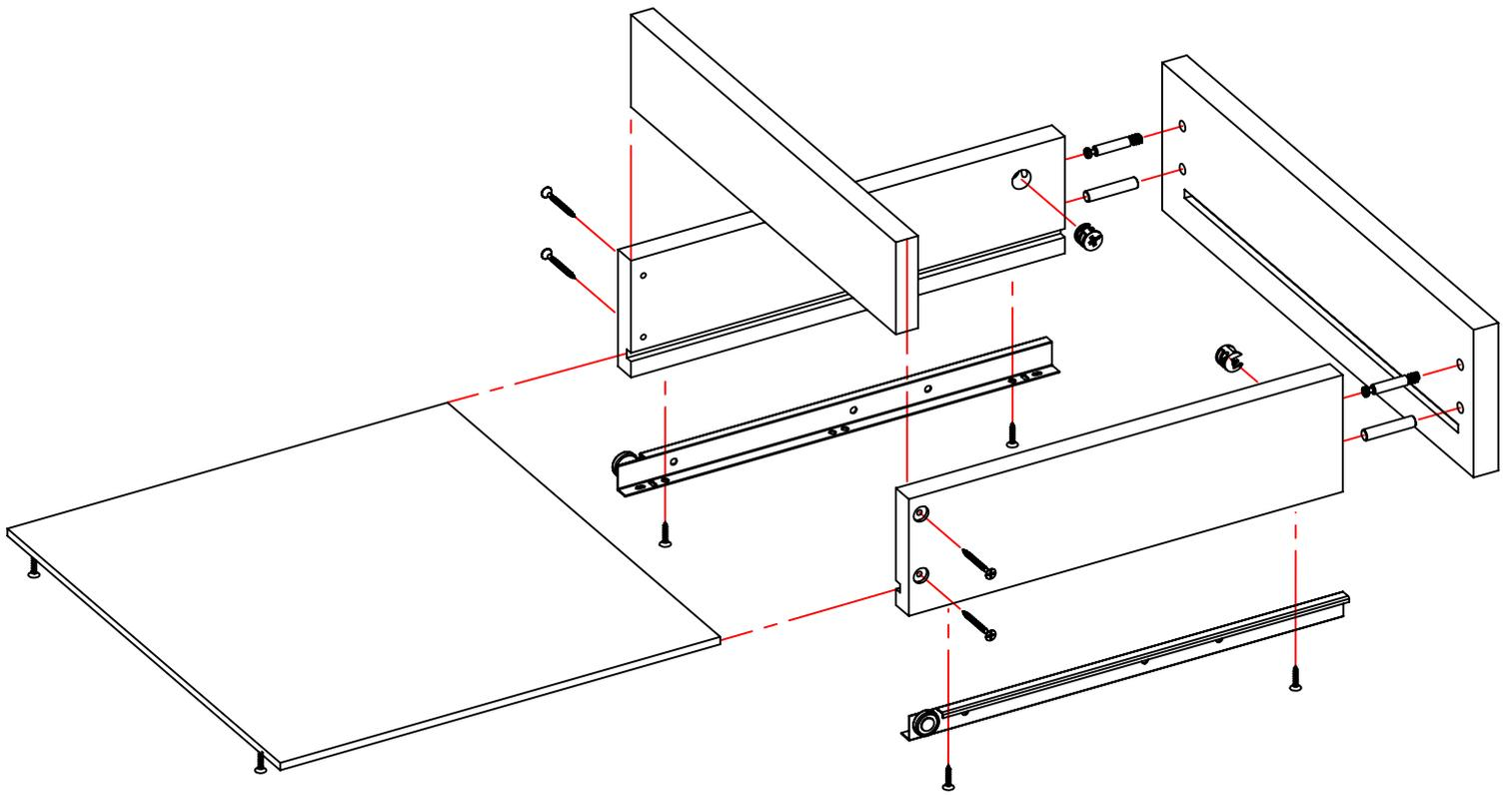
Шаг 6. Установить центральную стенку вертикально внутрь, соблюдая расстояние для свободного хода ящиков по направляющим. Убедившись в плавном ходе каждого ящика, зафиксируйте центральную стенку саморезами спереди и сзади.
