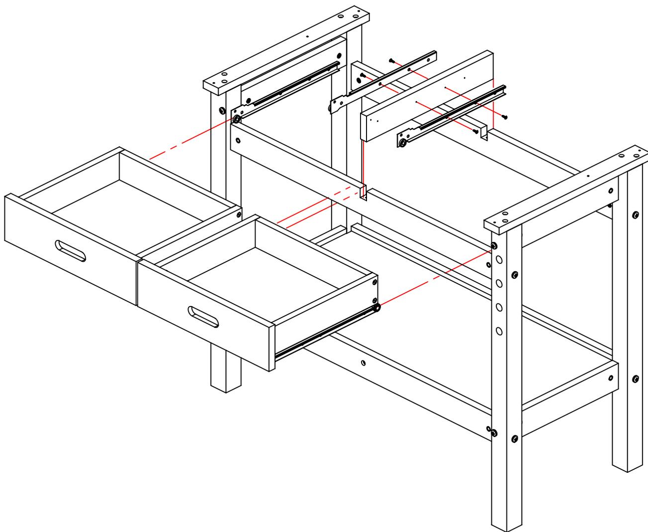
Шаг 6. При помощи малых и длинных саморезов, к внутренней части столешницы прикрепить две упор-гайки и две поперечины, соблюдая соосность под винт и направляющие. Убедившись в плавности хода, выкрутить винт и извлечь направляющие.
