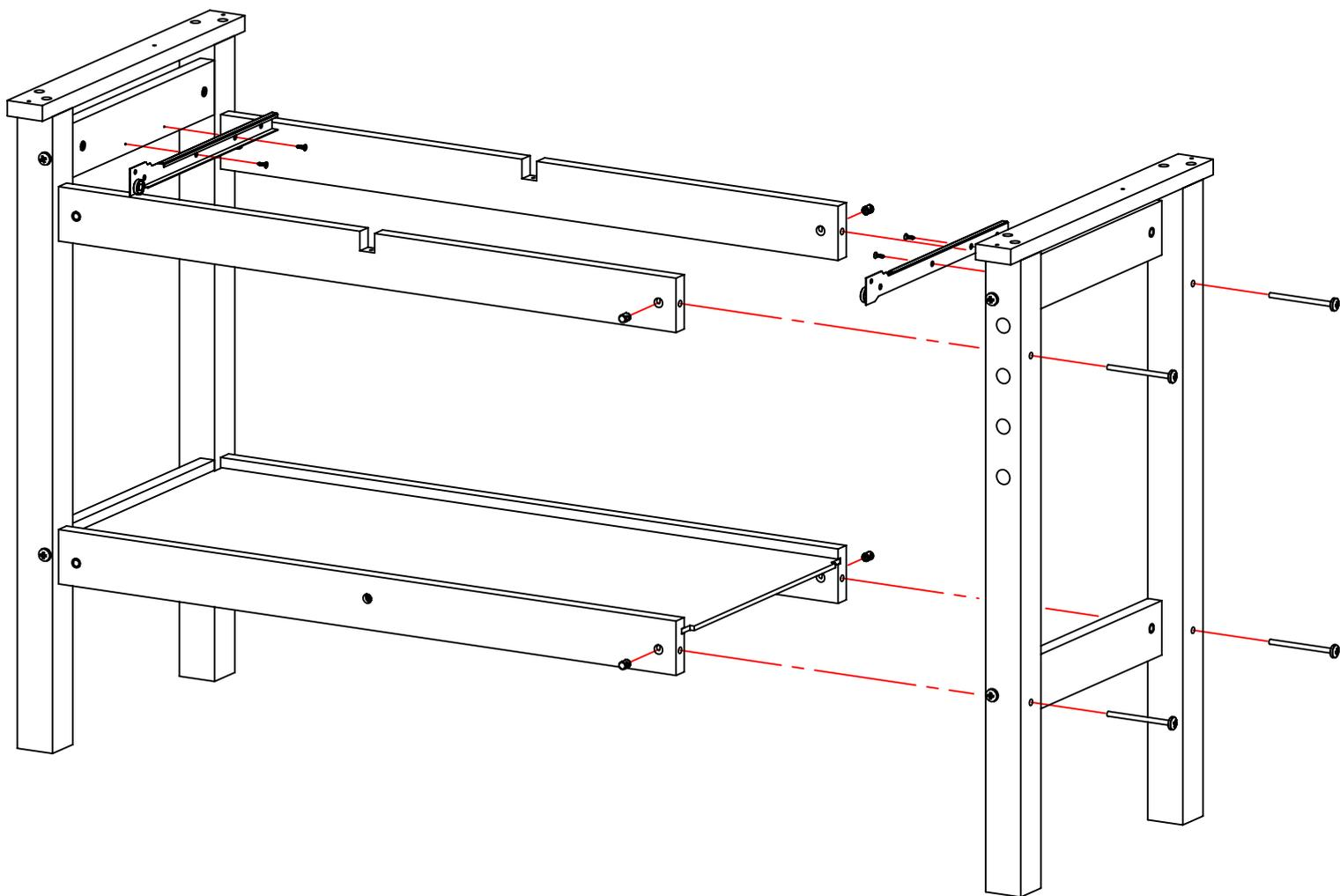
Шаг 4. Собрать два ящика с помощью фурнитуры по схеме. На схеме показана сборка левого ящика, если смотреть на лицевую сторону верстака.
