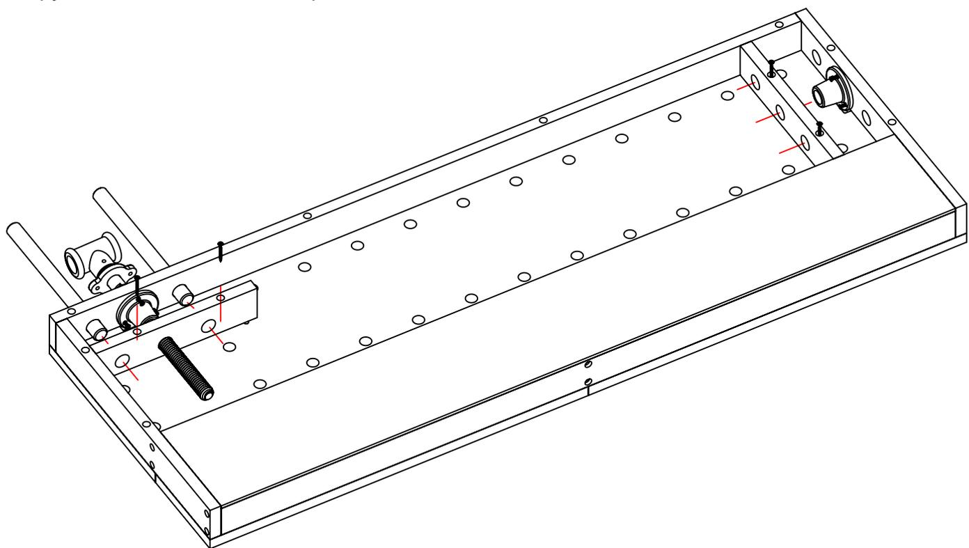
Шаг 7. Убедившись в плавности хода ящиков, притянуть верхнюю среднюю поперечину при помощи длинных саморезов. Зафиксировать столешницу к основанию верстака при помощи длинных саморезов.
