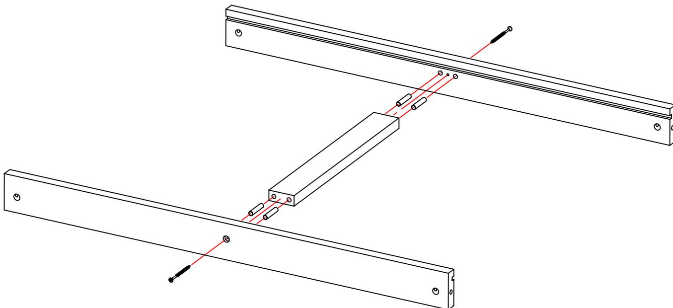
Шаг 2. Притянуть длинные поперечины к столбам с помощью винтов и гаек-бочонков. Соблюдайте параллельность пазов для захода полки. Установите полку в пазы до упора.
