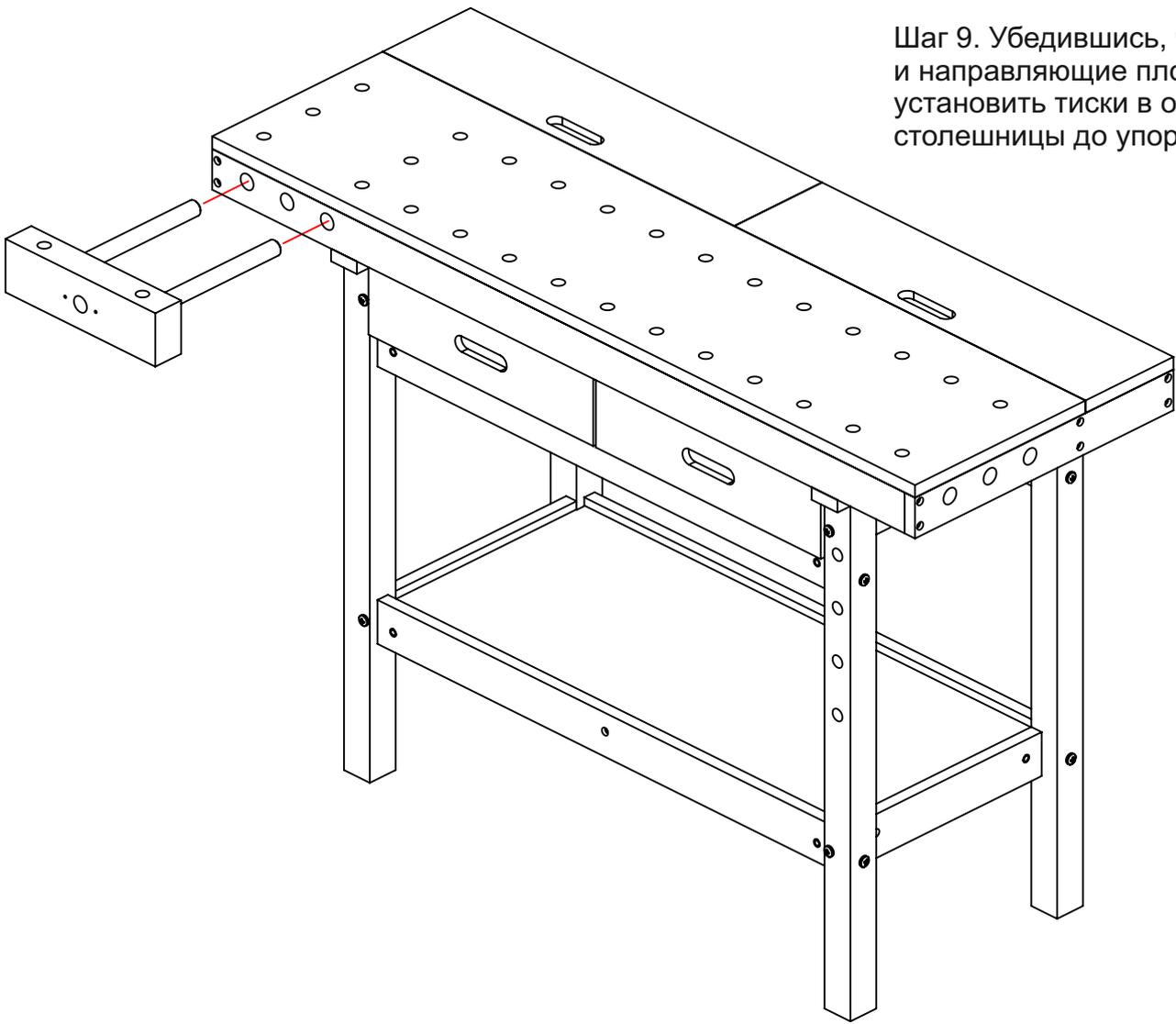
Шаг 10. Прикрепить винт к тискам с помощью средних саморезов. Вставить ручку в отверстие. Заглушки ручек притянуть малыми саморезами или приклеить.
