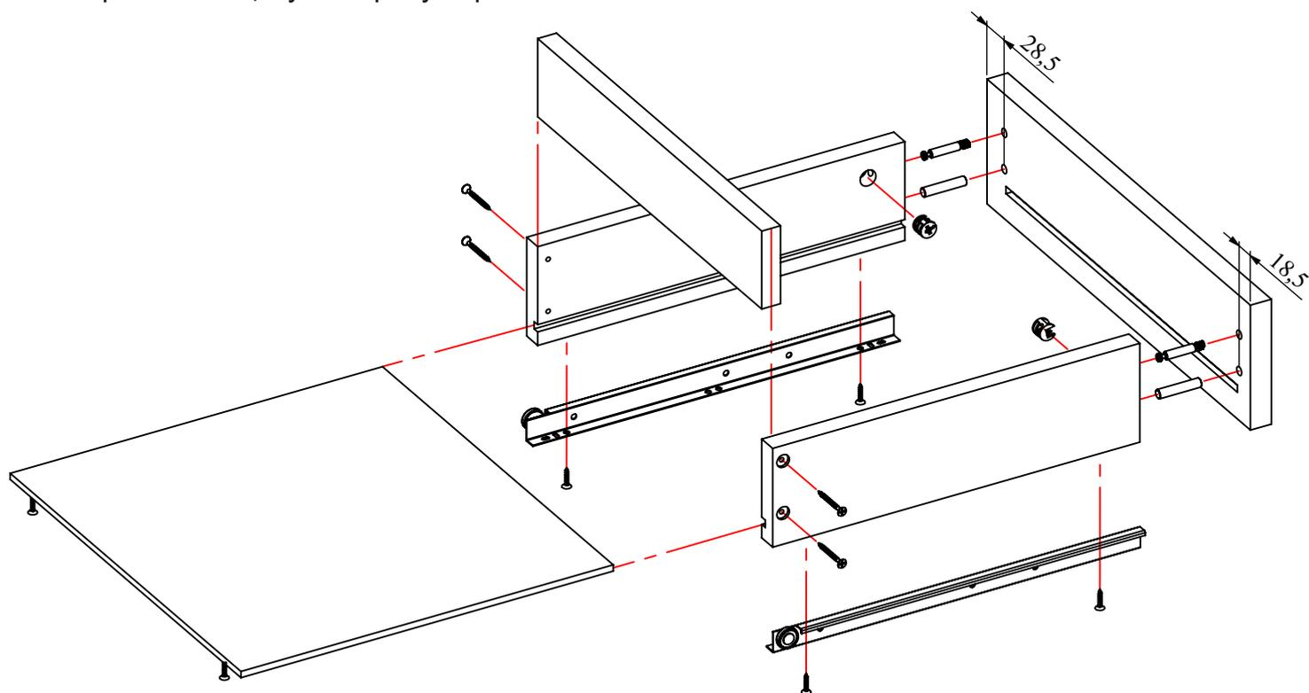
Шаг 5. Прикрепить роликовые направляющие для ящиков к верхней средней поперечине при помощи малых саморезов. Поперечину вставить перпендикулярно в пазы длинных верхних поперечин, пока непритягивая. Придерживая среднюю поперечину, проверить плавность хода ящиков.
