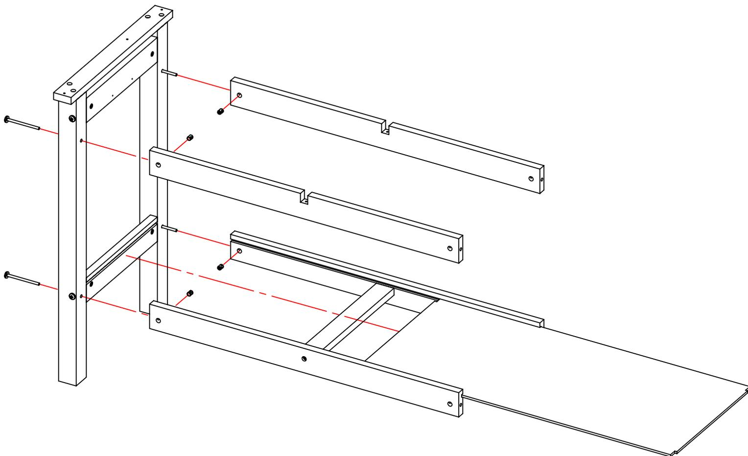
Шаг 3. Притянуть длинные поперечины к столбам с помощью винтов и гаек-бочонков. Прикрепить роликовые направляющие для ящиков к верхним коротким поперечинам при помощи малых саморезов.
