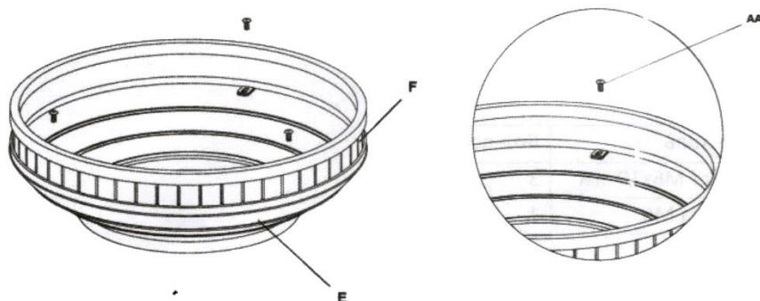
**Шаг 3:** соедините костровую чашу (D) с собранным основанием (E), повернув чашу по часовой стрелке направления.
