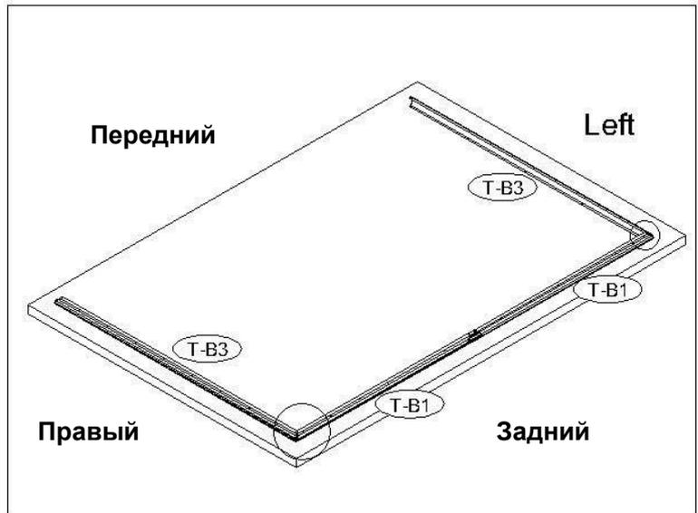
5. «Нахлестните» фронтальные штанги каркаса (Т-В4)&(Т-В5) на боковые (Т-В3) на обеих сторонах и скрепите их винтами (Т-В41) в обоих углах.
