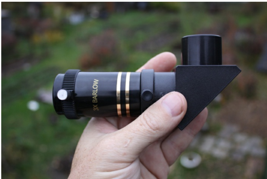
Диагональное зеркало с окуляром и линзой Барлоу
