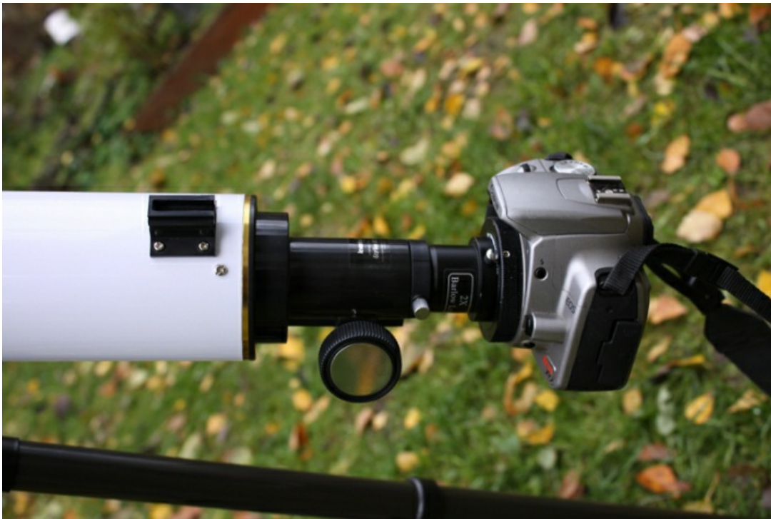
Установка фотоаппарата для съёмки в прямом фокусе
