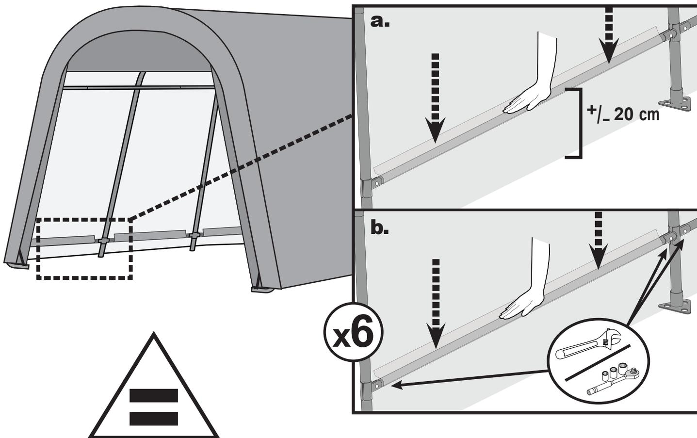
Синхронно натяните храповые механизмы: 1 и 2, затем 3 и 4.
